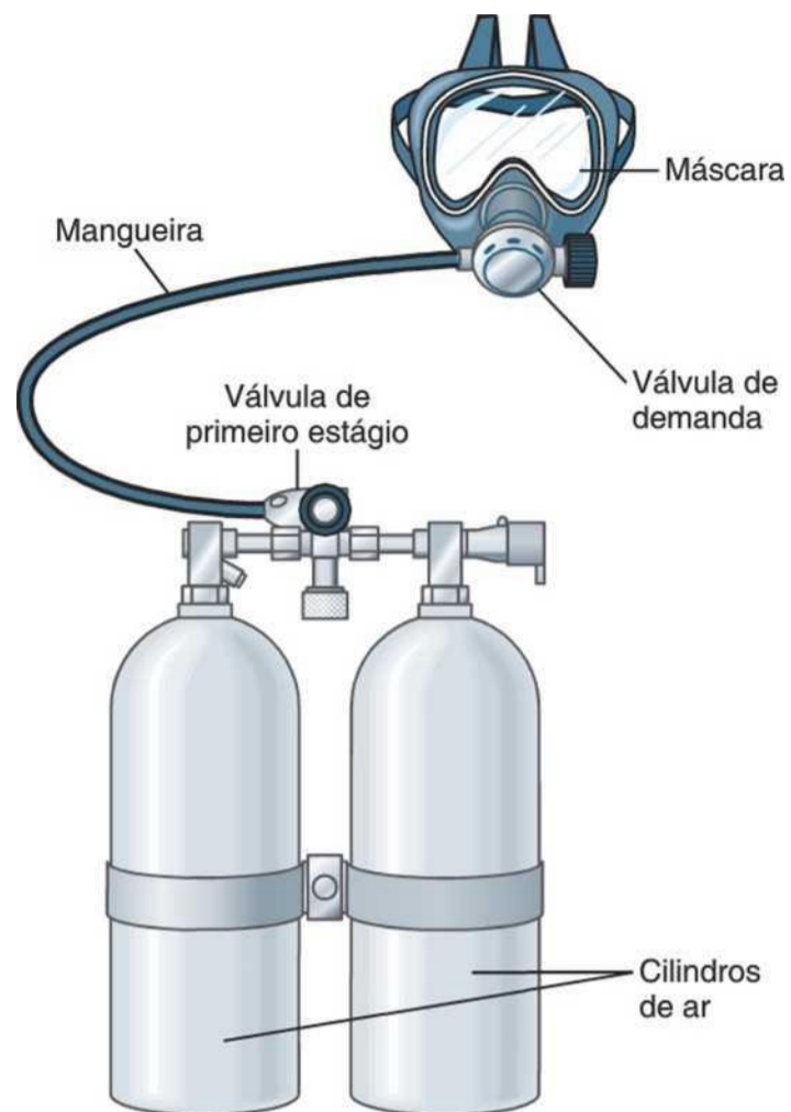
Figura 44-4 Aparelho SCUBA do tipo de demanda de circuito aberto.
